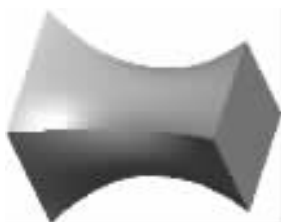
图 3-82 混合特征模型图——“光滑”
