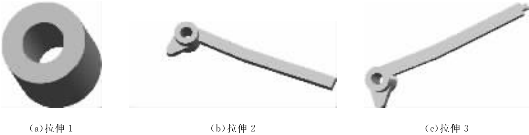
图 3-19 手压阀手柄主体的创建过程
