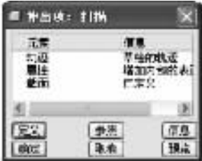
图 3-53 修改完扫描属性后的“伸出项:扫描”对话框
