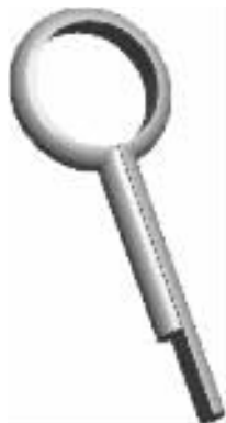
图 3-67 手压阀开口销的模型
