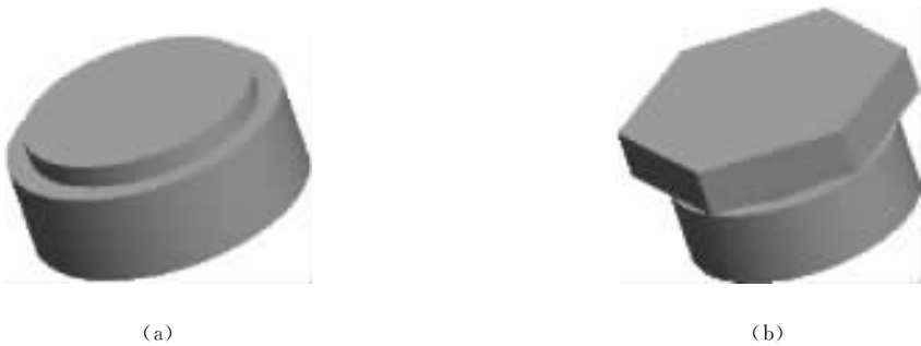
图 3-99 创建手压阀锁紧螺母的参考步骤
