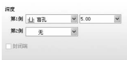
图 3-28 设置拉伸 3 的拉伸深度
