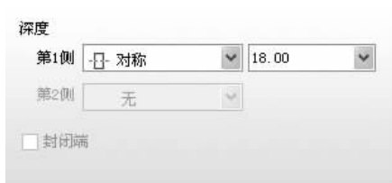
图 3-22 设置拉伸 1 的拉伸深度
