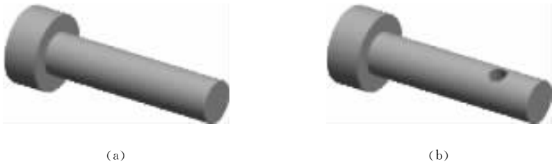
图 3-97 创建手压阀销钉模型的参考步骤
