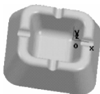
图 3-125 完成烟槽上表面的过渡
