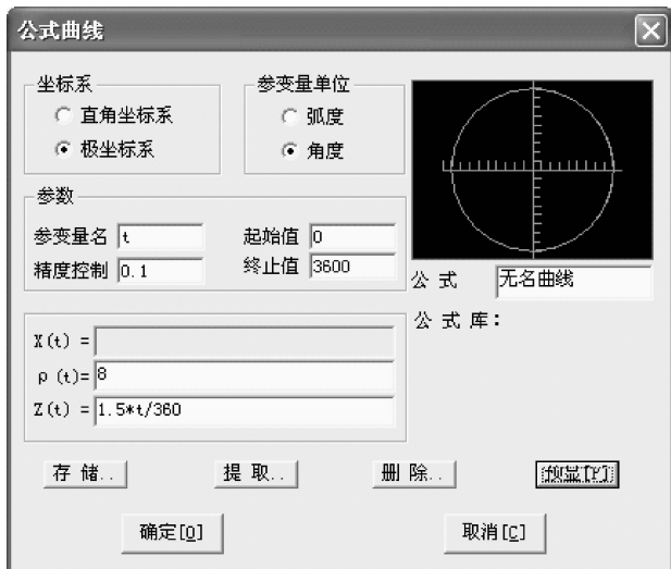
图 3-136 设置螺母螺旋线的参数
