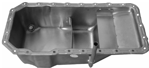
图 2-4 油底壳的构造
