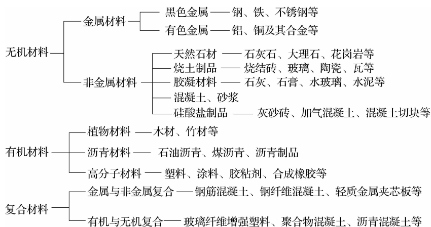
图 2-4 土木工程材料按组成及化学成分的分类
