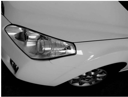
图 3-3 翼子板与发动机罩留有的缝隙应一致(图中车辆为新车)
