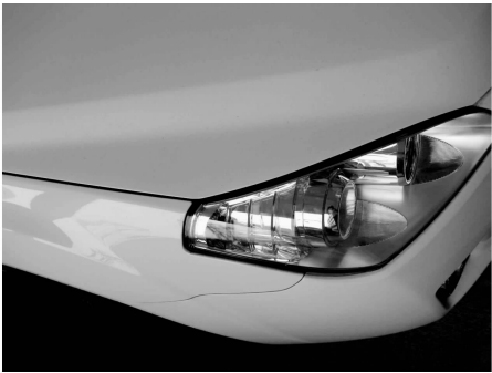
图 3-3 翼子板与发动机罩留有的缝隙应一致(图中车辆为新车)
