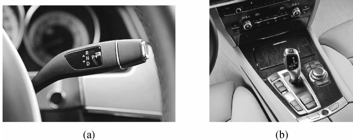
图 1-10 变速杆在汽车上的布置 (a)布置在转向柱上 (b)布置在驾驶室地板上
