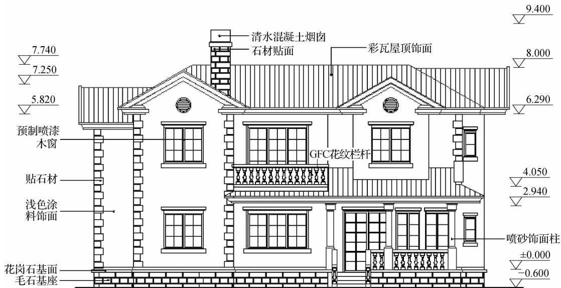
图 1-3 使用 AutoCAD 绘制的建筑二维施工图
