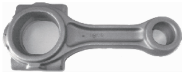
图 1-6 发动机连杆毛坯(大头孔合铸)
