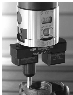
图 1-29 数显镗刀的快速微调装置
