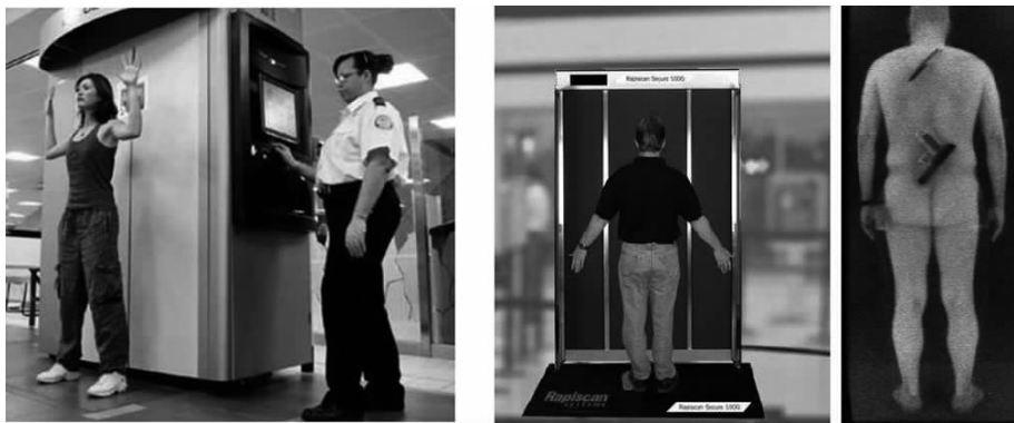
图 2-12 Secure 1000 X 射线背散射扫描仪
