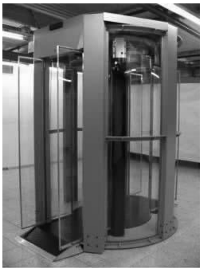
图 2-11 ProVision 毫米波成像安检门
