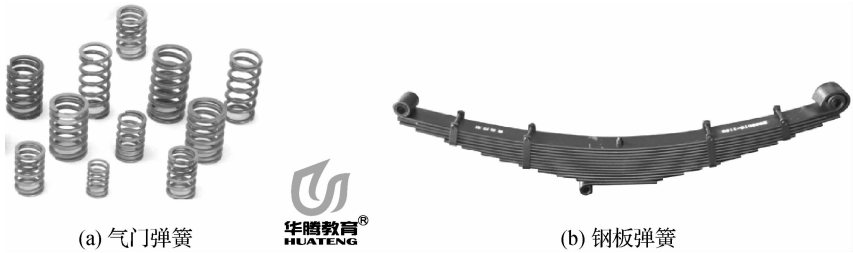
图 2-13 合金弹簧钢在汽车上的应用
