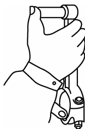
图 2-38 检验活塞销与连杆衬套的配合间隙
