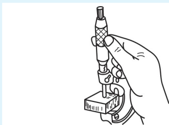
图 2-36 千分尺单手测量
