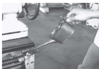
图 1-15 后托架储油池的注油润滑
