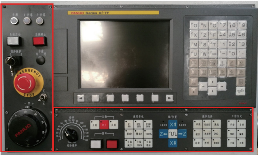
图1-2-2 FANUC Oi数控车机床操作面板
