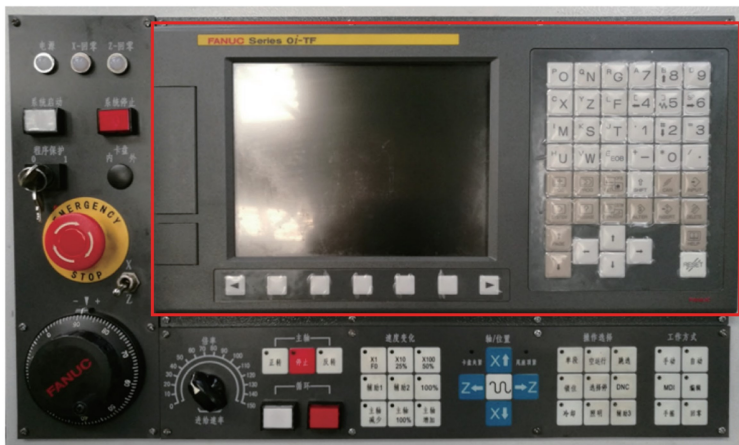
图1-2-1 FANUC Oi数控车系统操作面板
