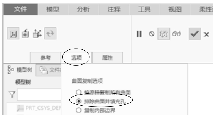
图4-25 选择“ 排除曲面并填充孔”选项
