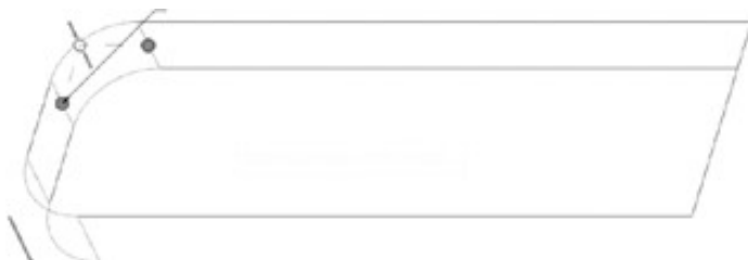
图2-8 选择两个角位的边线
