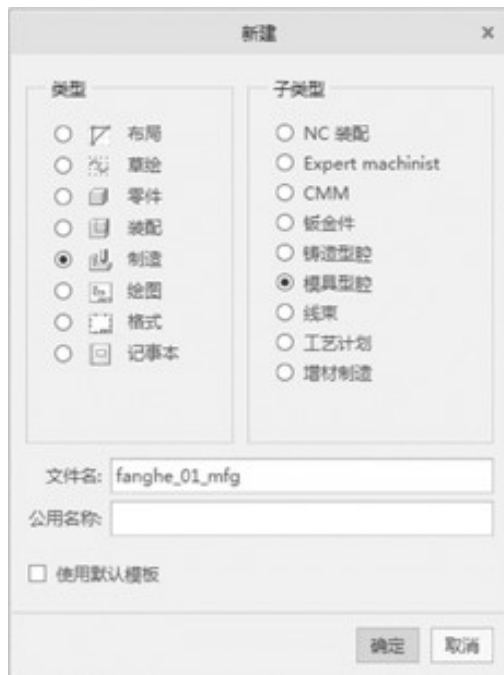
图1-15 选中“ 制造”，“子类型”为“ 模具型腔”
