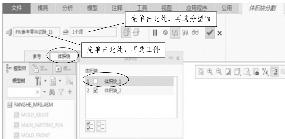
图1-41 先选择工件，再选择分型面
