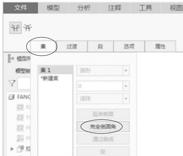
图2-9 单击“完全倒圆角”按钮
