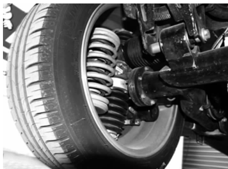
图 2-53 轮毂电机与悬架部分
