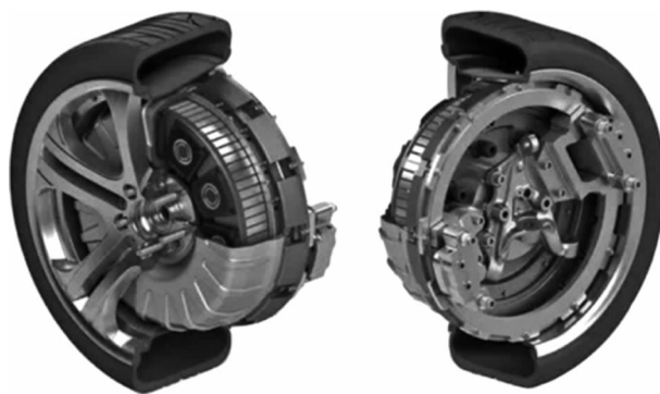
图 2-57 用于嘉年华电动汽车的轮毂电机
