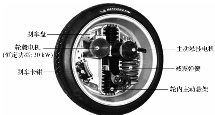
图 2-48 米其林电动汽车电动轮
