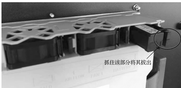
图 1-8 CNC 控制单元内锂电池的更换
