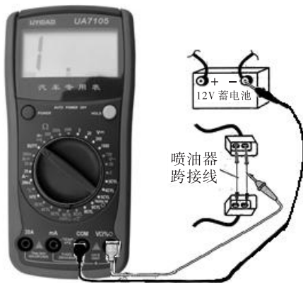
图 1-11 ADD81 喷油脉宽测试使用方法
