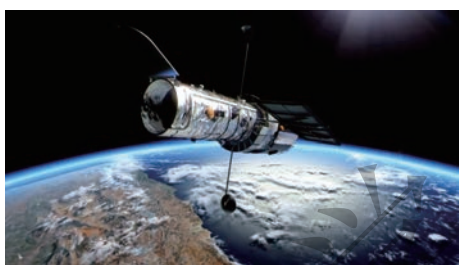
图 5.3-11 哈勃望远镜(其主、副镜均设计成双曲面形状)
