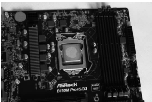
图 1-2-5 安装好 CPU 并涂抹硅脂
