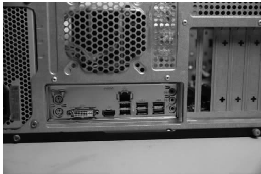
图 1-2-23 将主板 I/O 端口与挡板对应好
