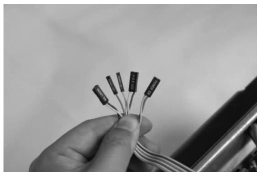
图 1-2-20 找到主板跳线
