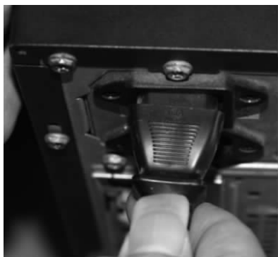
图 1-2-38 连接机箱电源线
