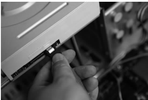
图 1-2-32 连接硬盘 SATA 接口的电源线
