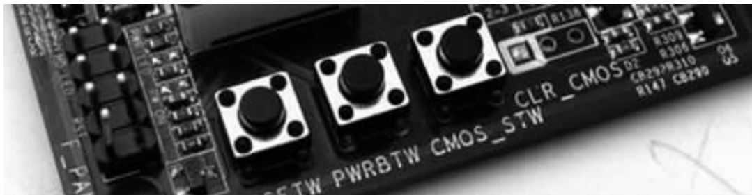
图 1-2-16 自带开机复位键的主板
