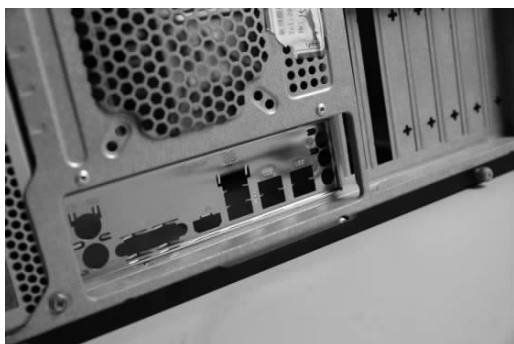
图 1-2-19 观察 I/O 端口位置与接口挡板
