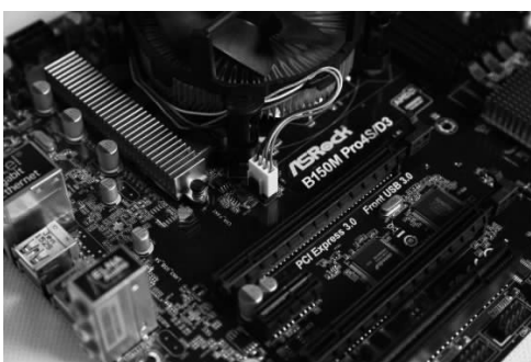
图 1-2-7 插好 CPU 风扇电源插座
