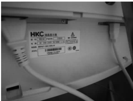
图 1-2-36 连接显示器电源线
