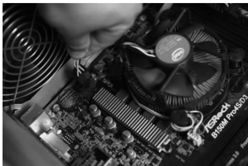
图 1-2-13 插入 CPU 辅助电源
