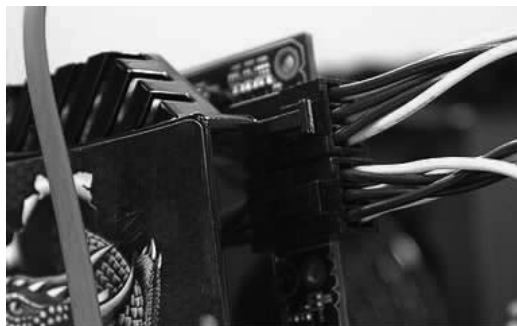
图 1-2-14 插入显卡电源线
