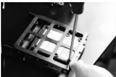
图 1-2-30 安装固态硬盘支架
