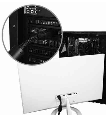
图 1-2-37 连接显示接口
