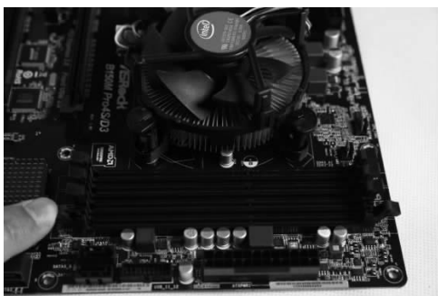
图 1-2-9 扳开两端的黑色卡扣
