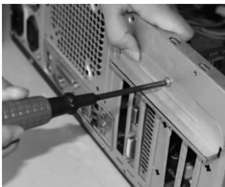
图 1-2-27 固定显卡挡板
