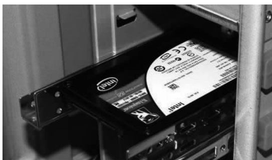
图 1-2-31 安装固态硬盘
