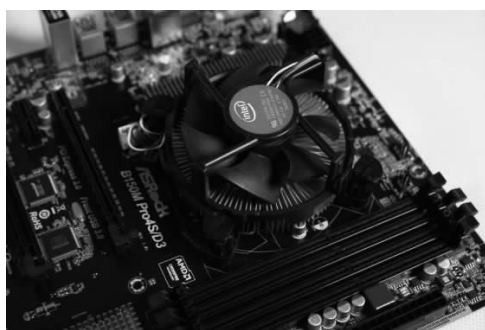
图 1-2-8 完成 CPU 和散热风扇的安装
