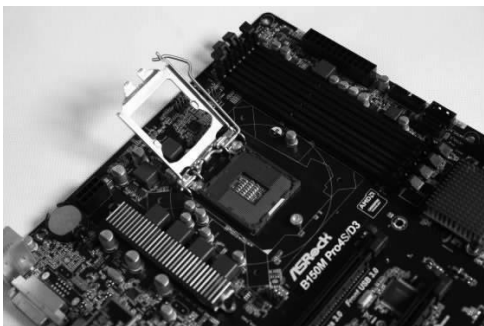
图 1-2-3 打开 CPU 拉杆
