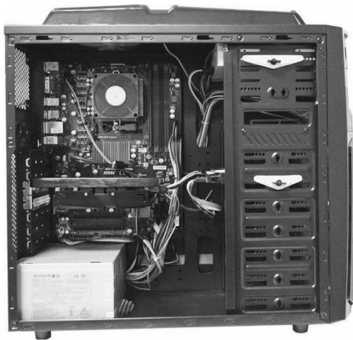
图 1-3 个人计算机主机的内部结构
