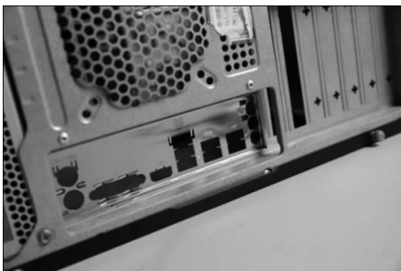
图 1-2-18 观察 I/O 端口位置与接口挡板
