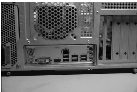
图 1-2-22 将主板 I/O 端口与挡板对应好
