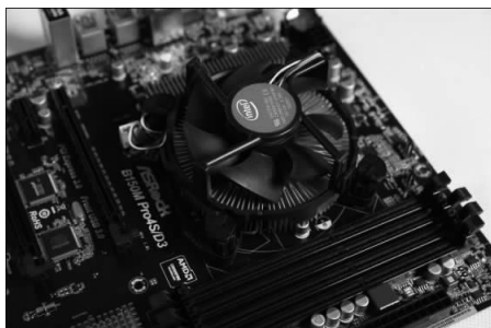
图 1-2-8 完成 CPU 和散热风扇的安装
