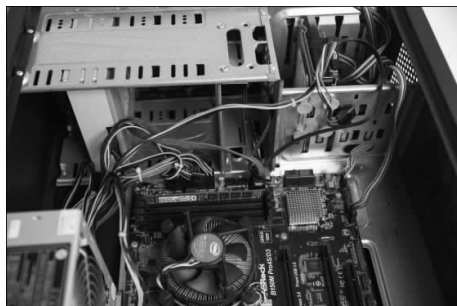
图 1-2-32 整理机箱内部布线
