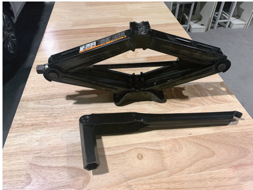
图 1-4-2 菱形齿条千斤顶
