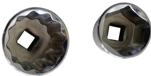
图 1-2-2 双六角形和六角形的钳口套筒头
