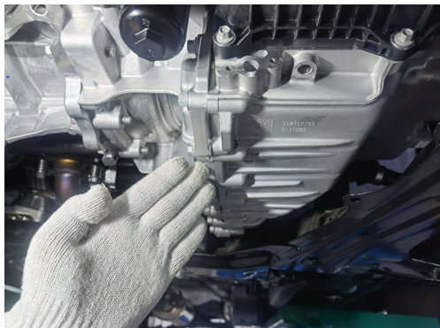
图 1-1-6 检查“四漏”现象
