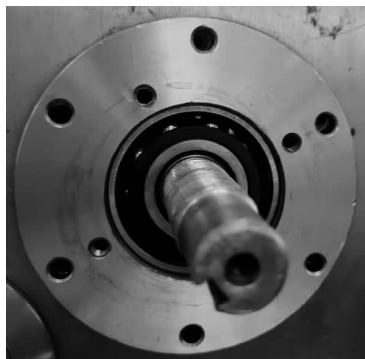
图 1-66 安装轴承座套
