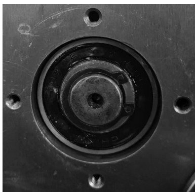
图 1-70 安装深沟球轴承和轴用定位卡簧
