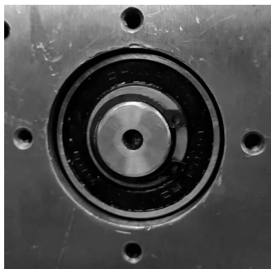
图 1-57 安装轴用卡簧
