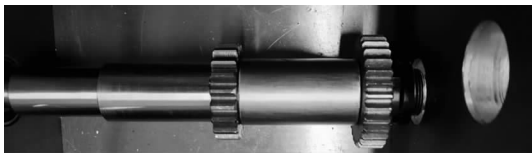
图 1-54 安装齿轮、齿轮套筒、锁紧螺母
