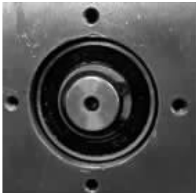
图 1-63 在主轴另一端安装深沟球 轴承和轴用卡簧
