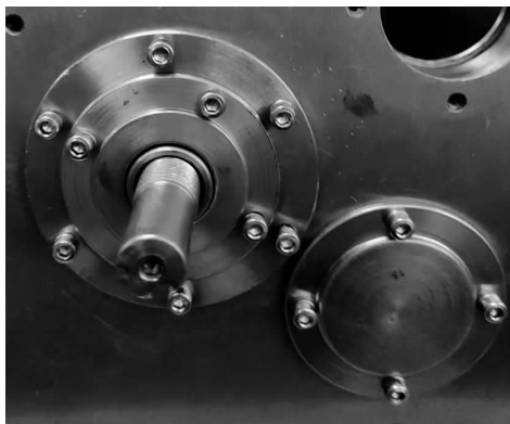
图 1-62 安装主轴轴承座套、轴承透盖、固定端 轴承内圈预紧套筒并锁紧
