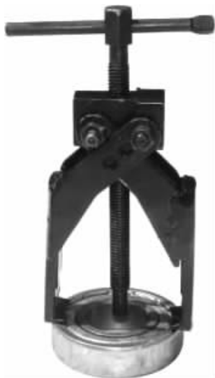
图 1-49 用专用拉具拆卸轴承
