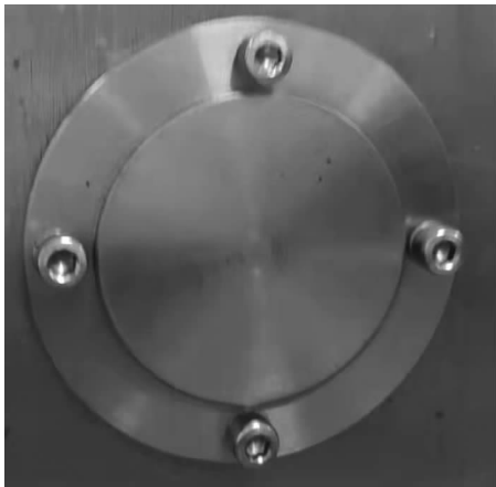
图 1-55 安装一端的闷盖
