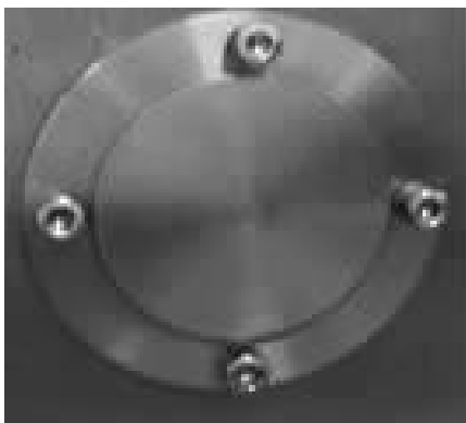
图 1-64 安装主轴另一端的闷盖
