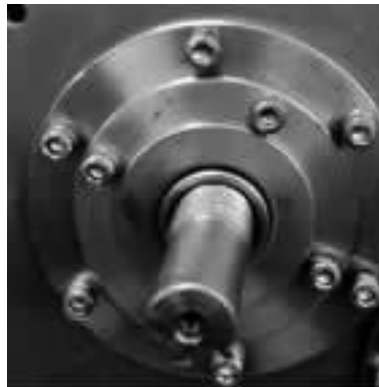
图 1-69 安装轴承透盖、固定端轴承内圈预紧套筒并锁紧
