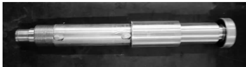
图 1-53 将深沟球轴承压装到固定轴一端
