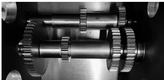
图 1-61 将主轴装入相应的箱体孔中
