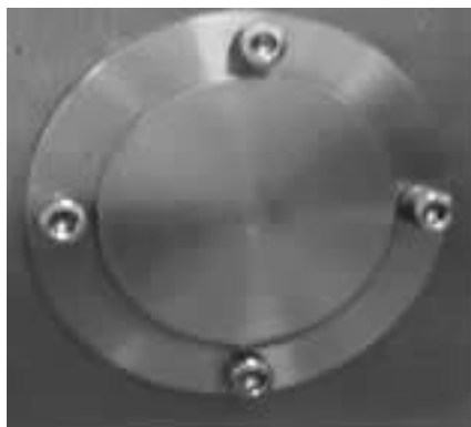
图 1-58 安装固定轴另一端的闷盖
