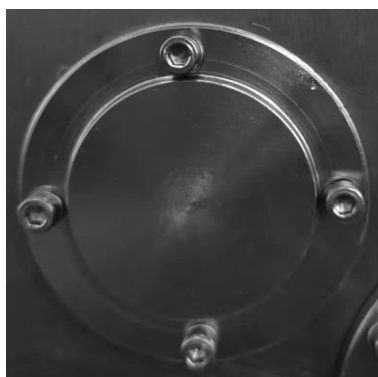
图 1-71 安装轴承闷盖
