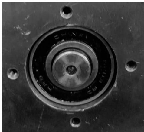
图 1-56 安装另一端的深沟球轴承
