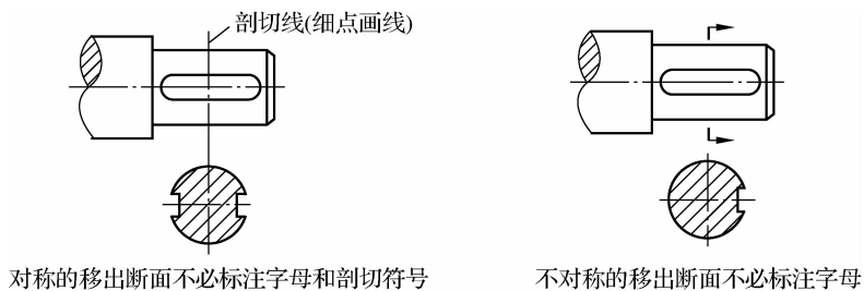
图 1-19 配置在剖切线或剖切符号延长线上的移出断面的标注方法
