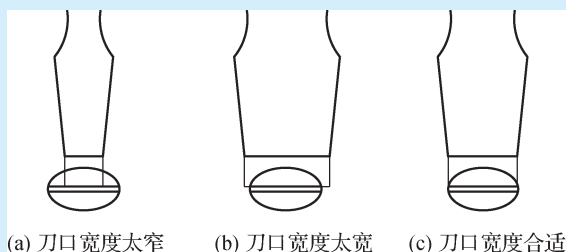
图 1-27 一字头旋具的使用宽度
