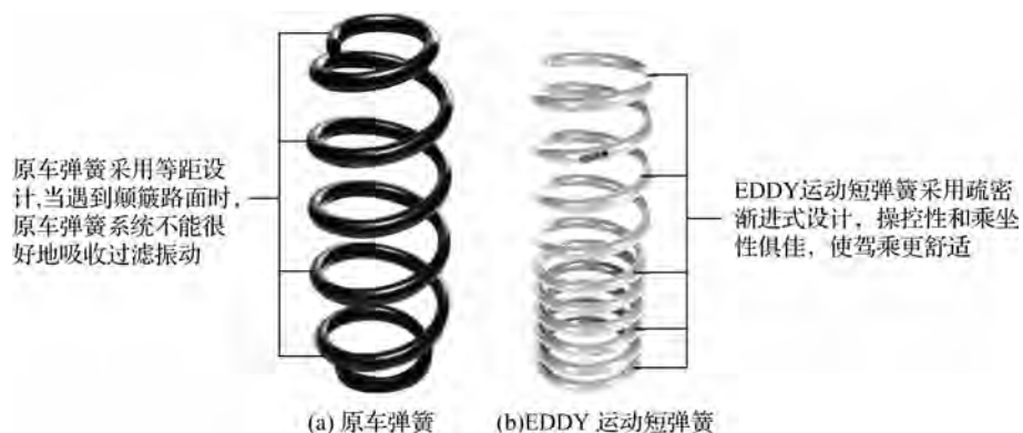
图 1-8 减振弹簧对比
