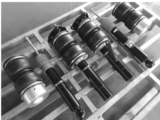
图 1-2 空气弹簧减振器
