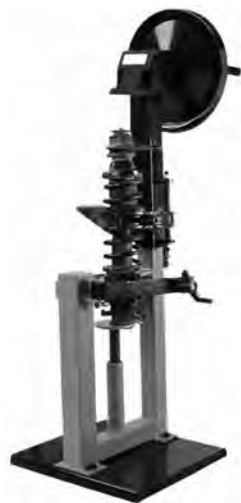
图 1-41 组装完毕的新减振器
