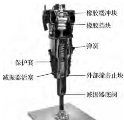
图 1-11 橡胶空气弹簧减振器的内部结构
