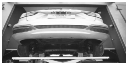
图 1-23 整体式底盘换电
