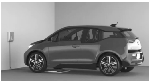
图 1-17 电动汽车静态无线充电方式
