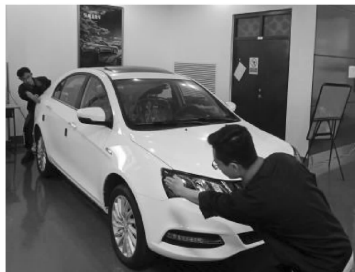
图 1-14 确认场地安全,目测车辆停放是否周正
