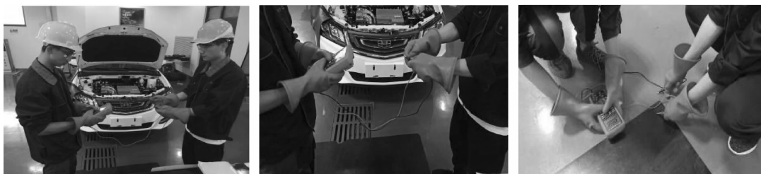
图 1-24 绝缘测试仪使用前做开路、短路测试以及检测绝缘垫的绝缘性
