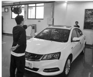
图 1-14 确认场地安全,目测车辆停放是否周正
