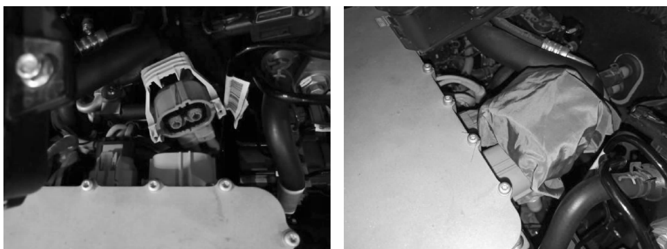
图 1-47 断开高压连接部件,静置 5 min
