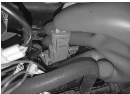
图 1-29 PTC 加热模块线束、插头检查
