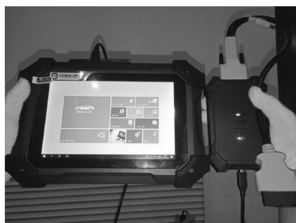
图 1-23 解码仪的连接及检查
