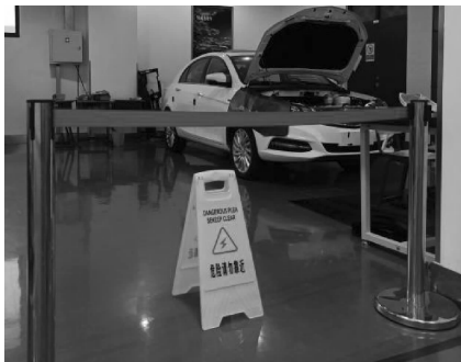
图 1-12 警示牌、围栏摆放检查
