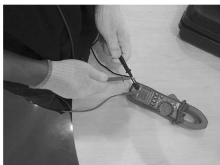
图 1-22 电流钳的校准
