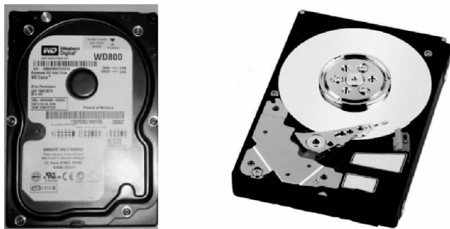
图 1-5 硬盘的外形及结构
