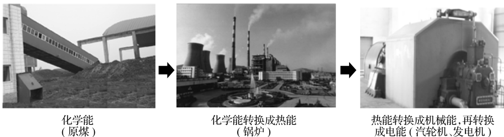
图 1-6 火力发电能量转换过程 2
