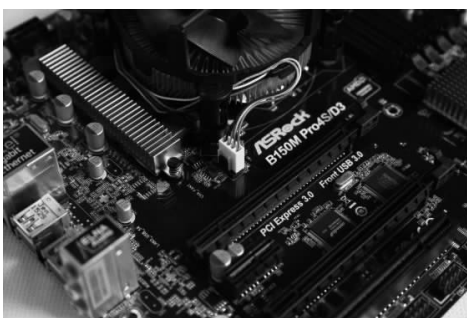
图 1-2-7 插好散热风扇电源接头
