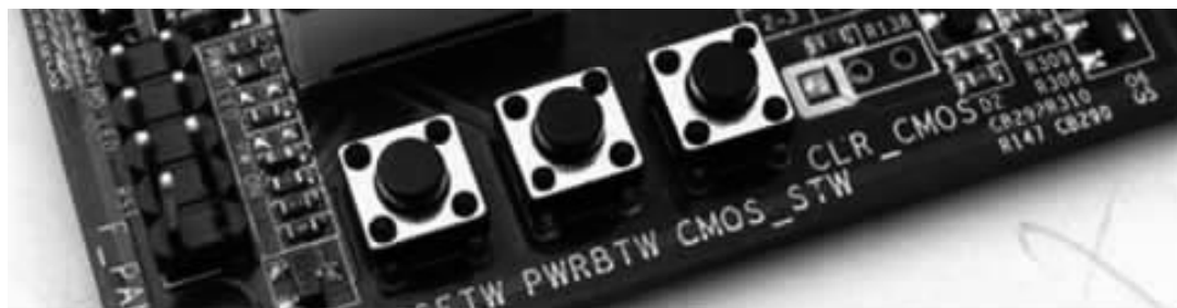
图 1-2-16 自带开机和复位按钮的主板
