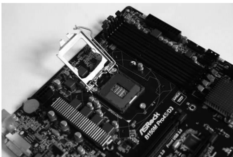
图 1-2-3 打开 CPU 压杆
