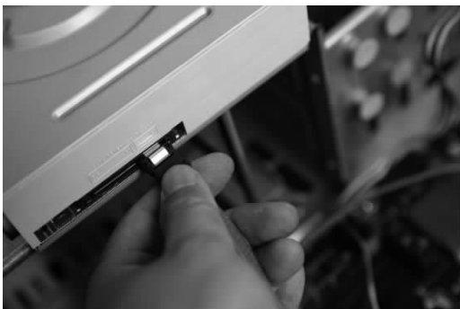
图 1-2-32 连接硬盘 SATA 接口的电源线
