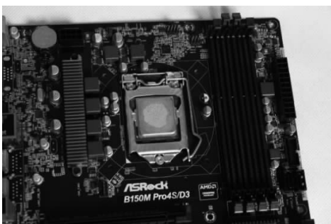
图 1-2-5 安装好 CPU 并涂抹硅脂
