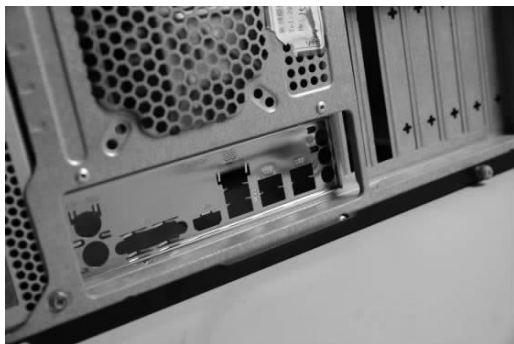
图 1-2-19 观察 I/O 端口位置与接口挡板
