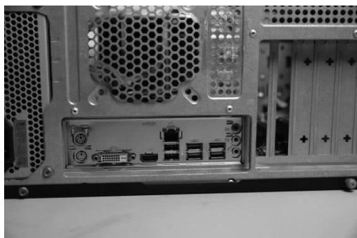
图 1-2-23 将主板 I/O 端口与挡板对应好
