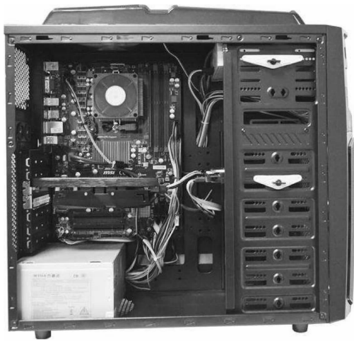
图 1-3 个人计算机主机的内部结构
