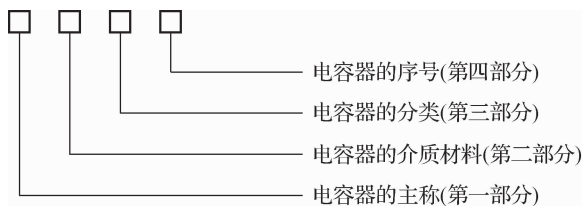
图 1-12 电容器的型号组成
