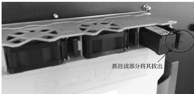
图 1-8 CNC 控制单元内锂电池的更换
