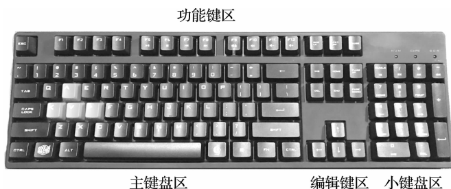
图 1-1 计算机标准键盘的结构
