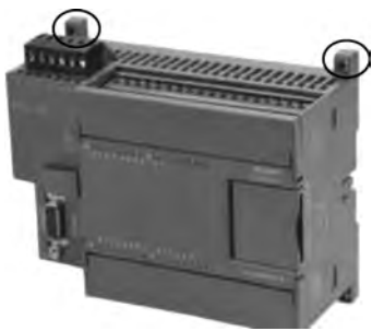
图 1-21 PLC 的底板安装
