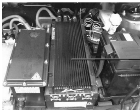
图 1-16 独立式 DC/DC 电源变换器(北汽新能源 EV160/200)
