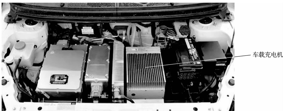
图 1-18 北汽新能源 EV160/200 独立式车载充电机
