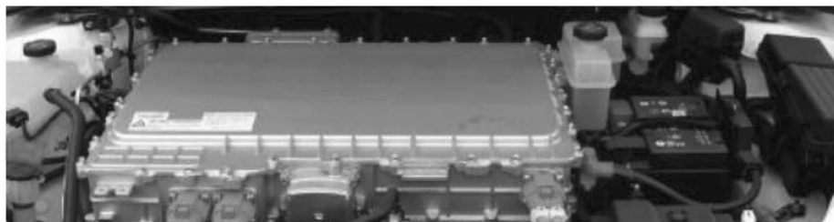
图 1-11 常见电动汽车的驱动电机及变速器总成
