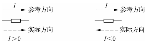
图 1-5 电流参考方向与实际方向的关系
