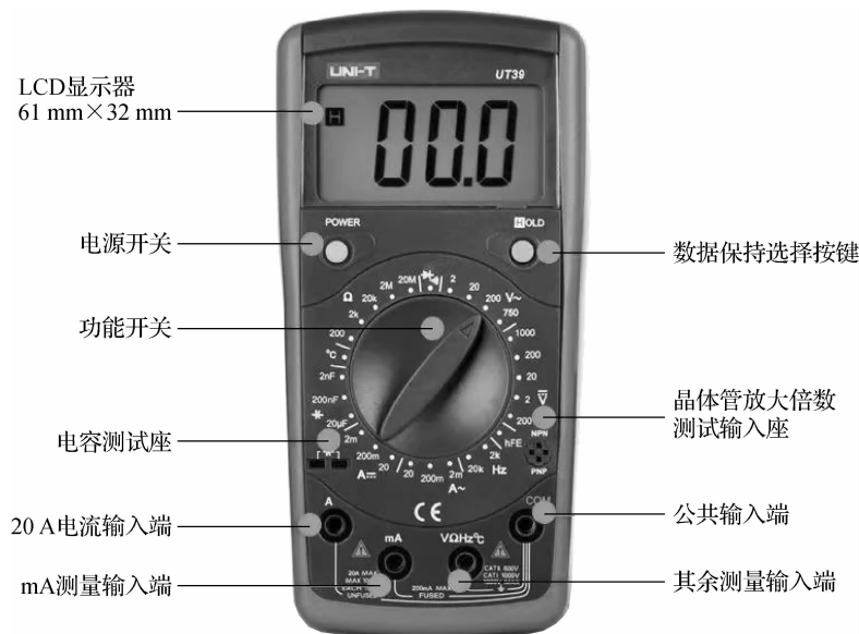
图 1-23 UT39 型数字万用表的面板结构
