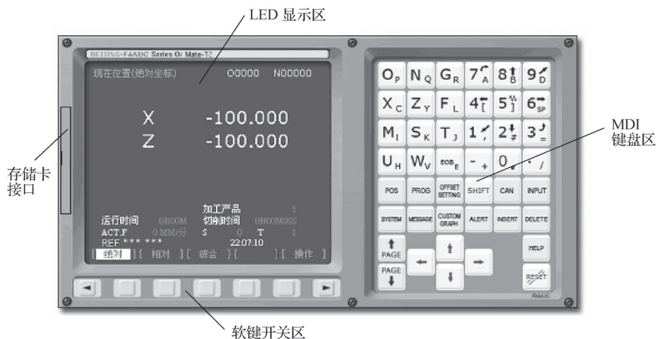
图 2-1 FANUC-0i Mate 操作面板
