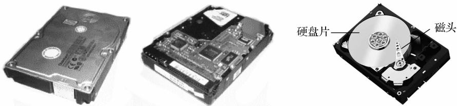
图 1-3 硬盘正面、反面及内部结构
