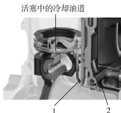
图 2-34 沃尔沃系列发动机活塞的喷油冷却装置
