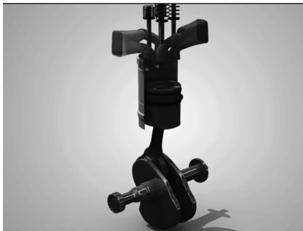
图 1-7 单缸发动机的工作过程
