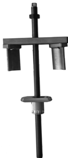
图 2-15 拆装气缸套专用工具
