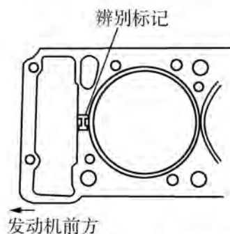
图 2-25 气缸垫上的标记
