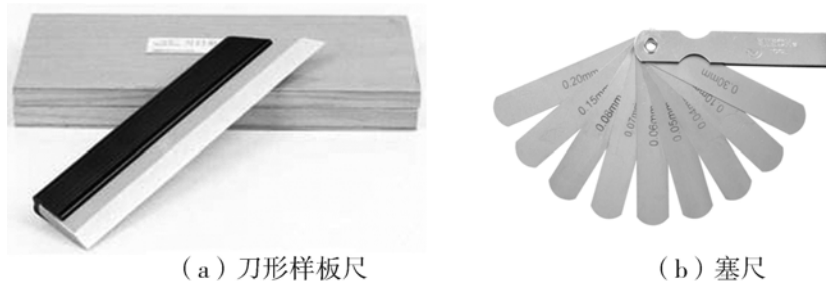
图 2-9 气缸体变形测量工具
