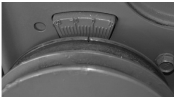
图 2-112 刻在前端皮带盘上的第一缸上止点记号
