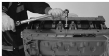
(d) 用规定力矩拧紧连杆螺栓
