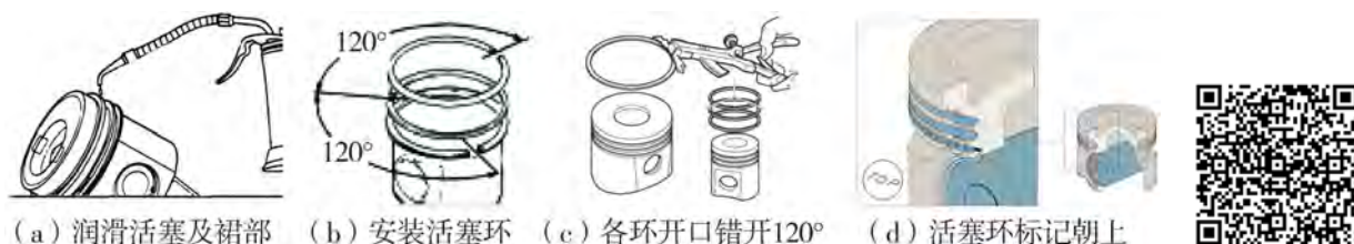
图 2-61 活塞环的安装
