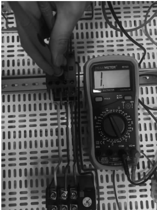
图 2-3-2 万用表检测接点通断
