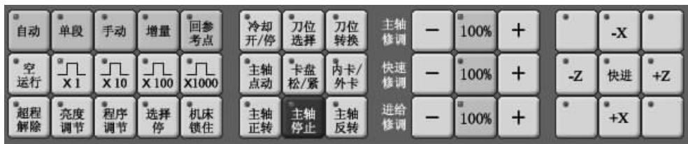
图 1-21 数控车床控制面板
