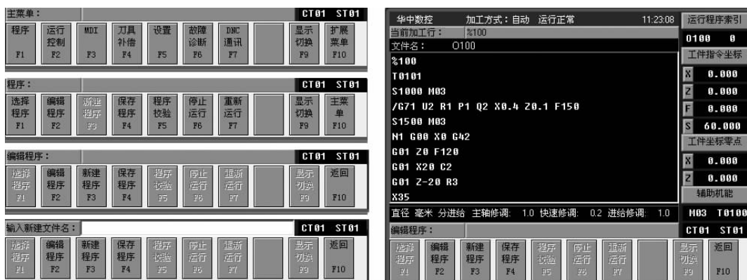
图 1-19 程序编辑流程图
