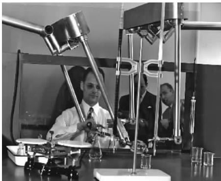
图 1-28 使用电动机械遥控操作机器人处理放射性物质
