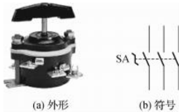
图 1-3 组合开关的外形和符号
