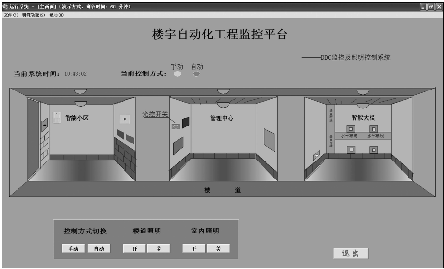
图 1-1 照明系统的监控界面
