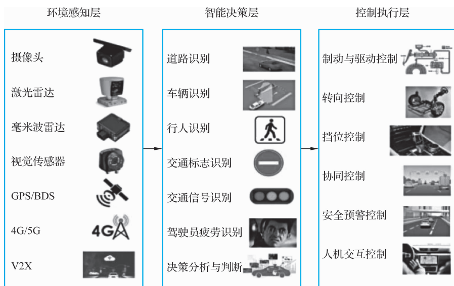
图 1-9 智能网联汽车的层次结构
