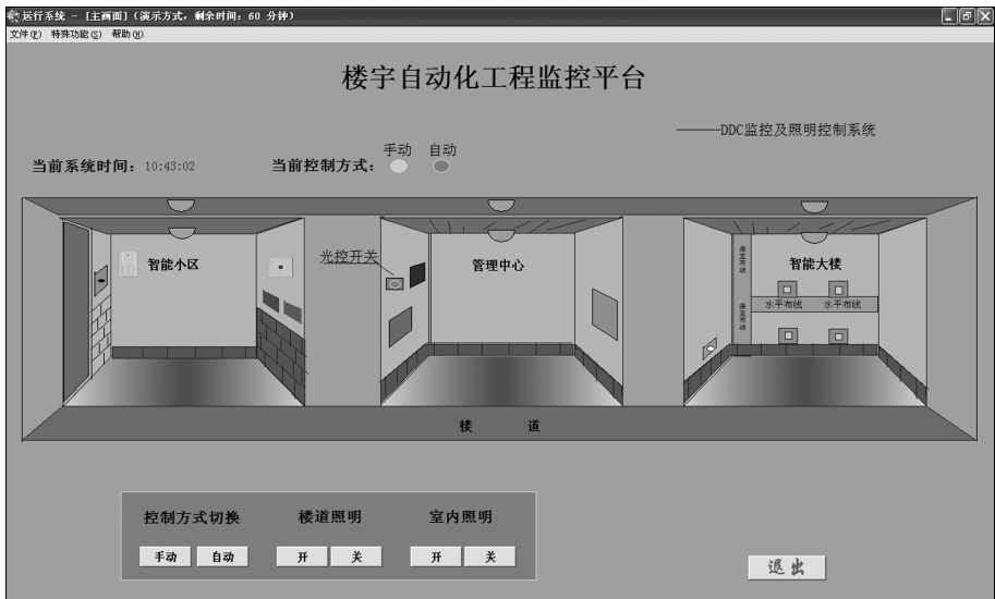
图 1-1 照明系统的监控界面
