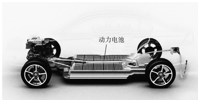
图 1-1-16 纯电动汽车的动力电池通常布置在车辆底部
