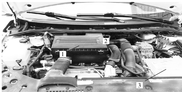
1—发动机；2—电动机；3—电动机控制器。
