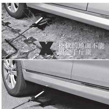
图 1-1-7 千斤顶底部地面要坚固
