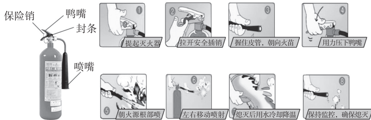
图 1-1-12 灭火器的使用方法
