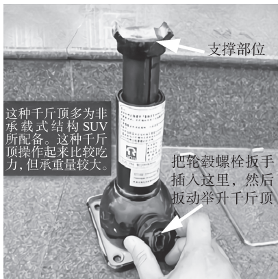
图 1-1-5 螺旋千斤顶
